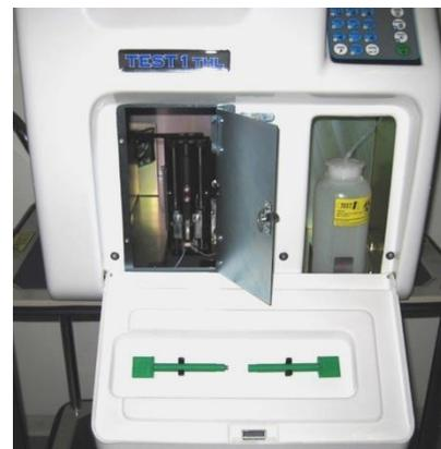
Appuyez sur **ENTER** pour remettre l'ensemble du piston en position initiale et fermez les portes.
