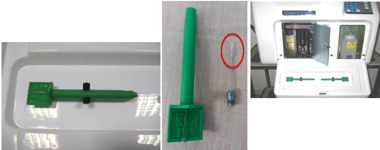
Prenez le nouveau kit (SI 195077), retirez l'aiguille de l'outil vert, enlevez le caoutchouc de protection de la pointe de l'aiguille, insérez de nouveau l'aiguille à l'intérieur de l'outil en plastique et insérez-la dans le trou du piston et serrez-la.
