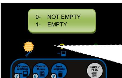
Si l'écran affiche ce message, alors que le voyant gauche clignote, cela signifie que le réservoir est plein de liquide. Il faut le vider et appuyer sur la touche **1** pour remettre le compteur à zéro. Des informations détaillées sont présentes à la section **18 REMPLACEMENT DU RÉSERVOIR**.
