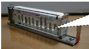
Comme pour cet exemple, insérer les éprouvettes dans un rack en commençant par la première position sans laisser de positions vides et l'étiquette code barre qui sort du côté de la fente. Insérez ensuite le rack utilisé dans le laboratoire dans l'adaptateur métallique adapté conçu pour supporter le rack.
