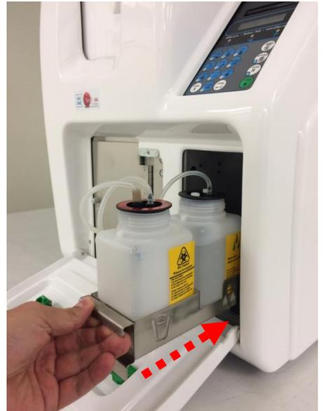
Profitez-en pour remplir à nouveau le réservoir d'eau, même s'il ne semble pas vide. Remplissez jusqu'au repère des 500 ml. Si vous le souhaitez, vous pouvez également retirer le réservoir d'eau pour le remplir facilement. Enfin, poussez le guide de chargement et fermez le couvercle en plastique avant.
