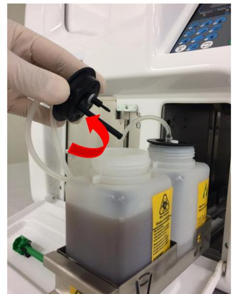
Ouvrez la porte avant en plastique, sortez le support de chargement et retirez le couvercle du réservoir à déchets.
