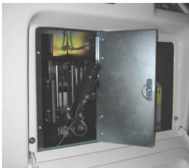
Poussez doucement l'assemblage du piston à l'intérieur de l'instrument jusqu'à ce que les aimants carrés le retiennent verticalement et verrouillez l'assemblage du piston en tournant la vis de retenue.
