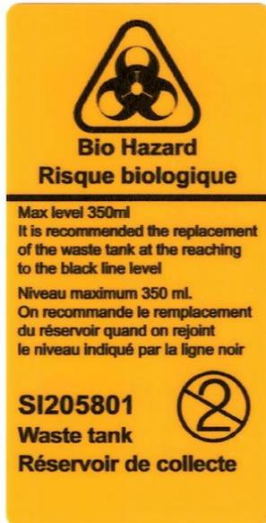
Étiquette de danger biologique avec des indications sur le remplacement de la cuve
